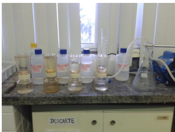
Figura 3: Sistema de filtração à vácuo utilizado nas análises de STS do córrego Pau Amarelo (ES).
